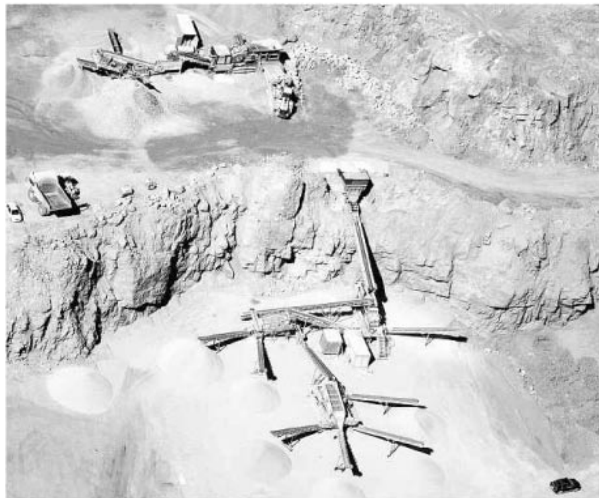
Wie eine Spinne sieht die neue Brech- und Siebanlage auf der unteren Sohle aus. Sie wird mit Halbprodukten aus dem mobilen Backenbrecher gespeist, der zwölf Meter höher auf der Abbauebene arbeitet. Fotos: J. Lange
